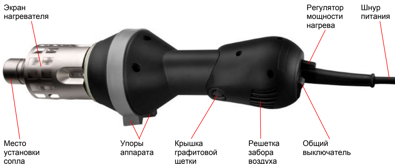
Рис. 1 Органы управления аппарата HOT AIR S
